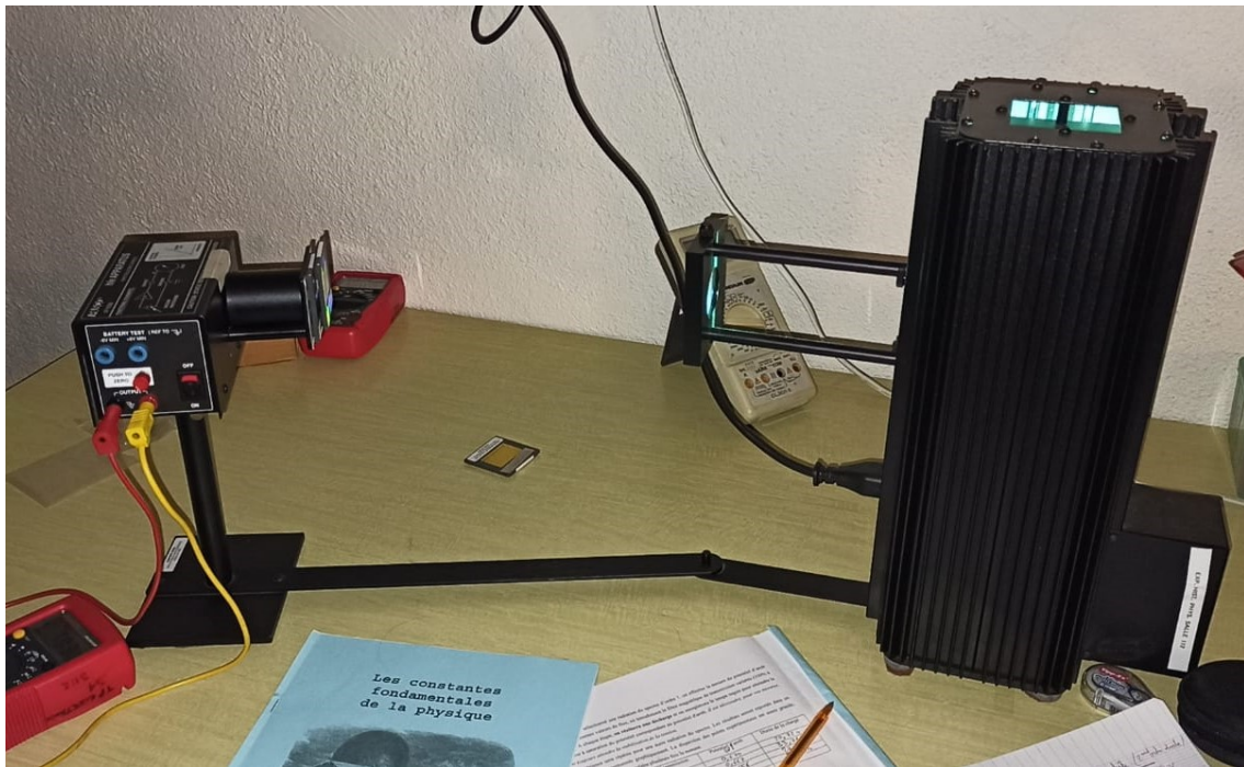
Photo du montage utilisé (cellule photoélectrique à gauche et lampe à vapeur de Hg à droite)
